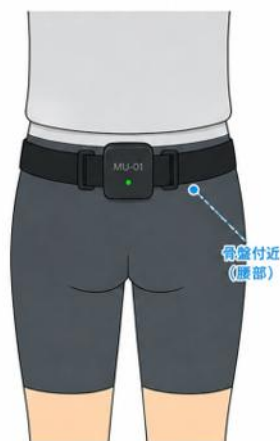
1. MU-01を被験者の腰部、骨盤付近に取り付けます。
